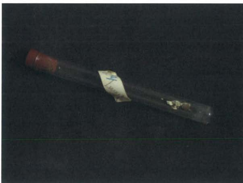
Fig. 4 – Frammenti di campione prelevati dalla zona delle lunette conservati in provette con l'etichetta identificativa.
